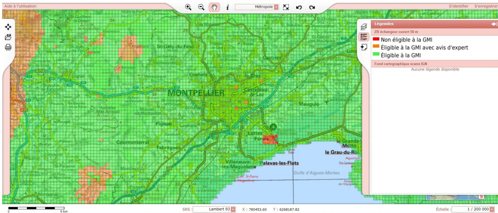
Figure 135 : Zonage réglementaire pour le développement de la géothermie de mine importance – systèmes ouverts de 50 à 200m de profondeur, source : BRGM
