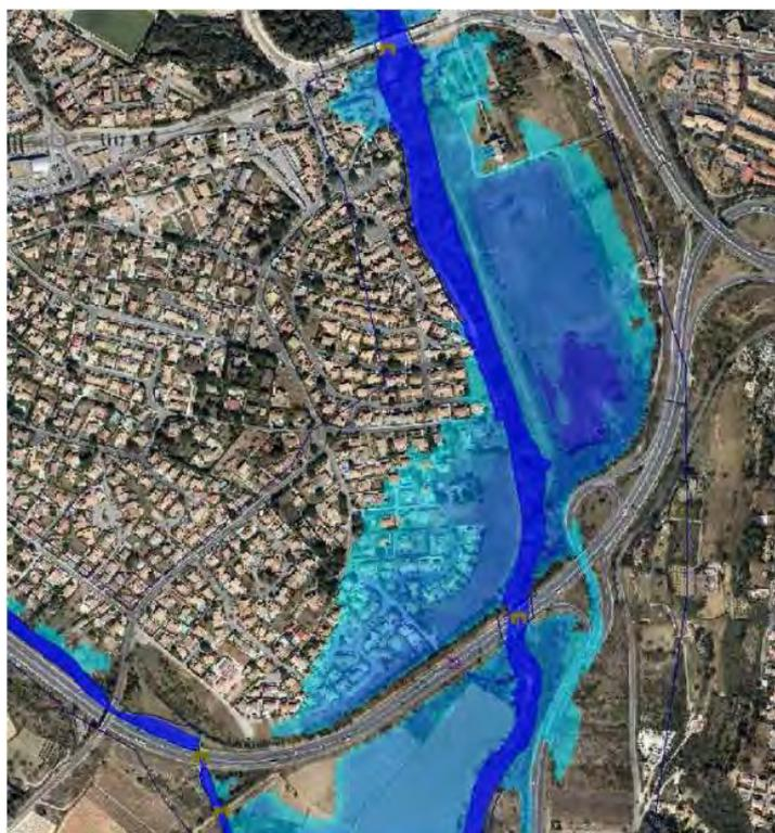
FIGURE 50 : INONDATIONS POUR UN DEBIT SUPERIEUR A 400 M<sup>3</sup>/S (SOURCE EGIS EAU 2015)
