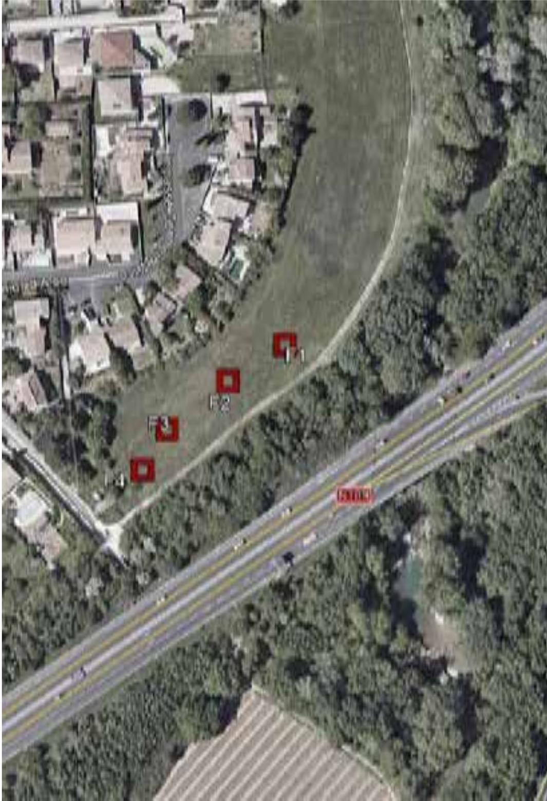
**Le nombre d'essais réalisés en phase G2 AVp et en phase PRO semble cohérent avec le projet de digue sur Juvignac. La densité de sondages est représentative de chaque secteur de digue, de plus les différents types de sondages sont cohérents avec les besoins géotechniques sur le secteur d'étude.**
