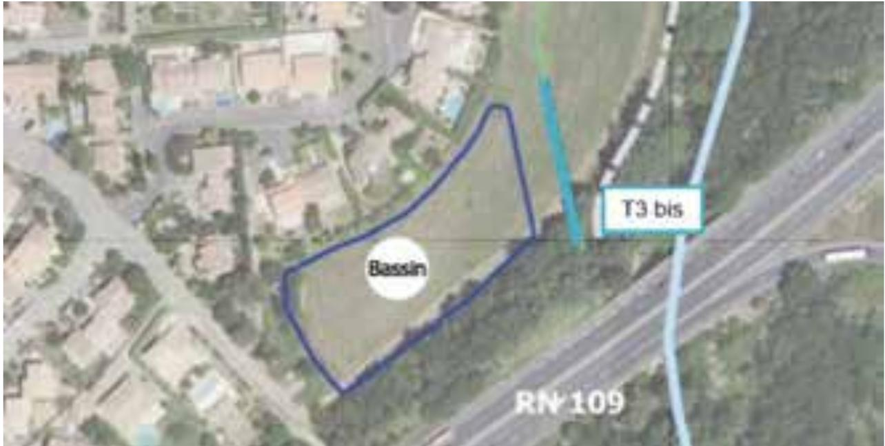
Au droit du bassin, la topographie est d'environ 29,6 à 30 m NGF. Le fil d'eau amont de l'émissaire sous la RN 109 est positionné à 28,8 m NGF environ.
