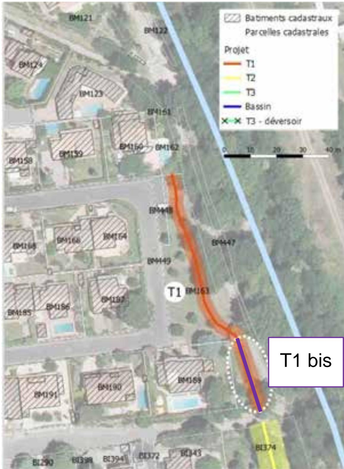
Le plan d'ensemble des aménagements prévus sur le tronçon T1 est présenté sur la figure ci-après. L'accès à la crête de la digue se fera depuis une rampe qui connectera l'ouvrage à la rue Georges Brassens.
