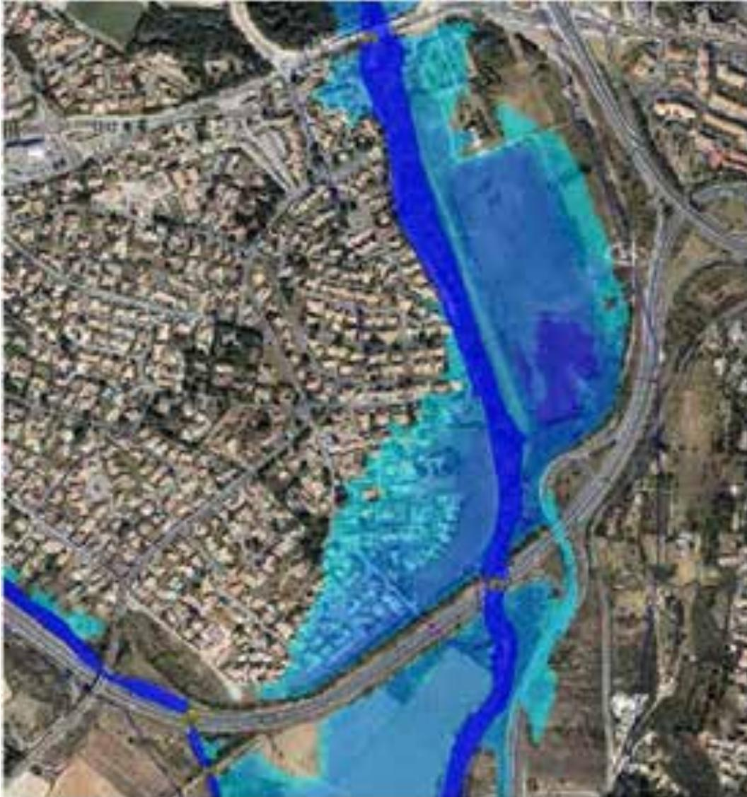
D'après les cartographies ci-dessus et les cartographies issues du modèle de l'EDD présentes aux pages suivantes, le modèle de l'EDD semble représenter de manière précise les écoulements hydrauliques de l'état avant-projet de digue.
