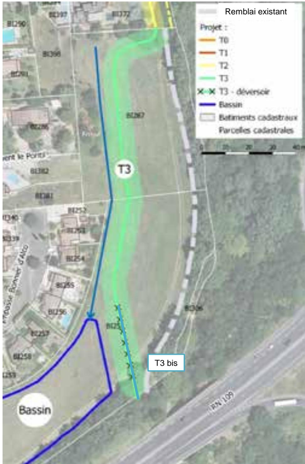
Figure 113 : Vue en plan du tronçon T3 bis (1/2)
