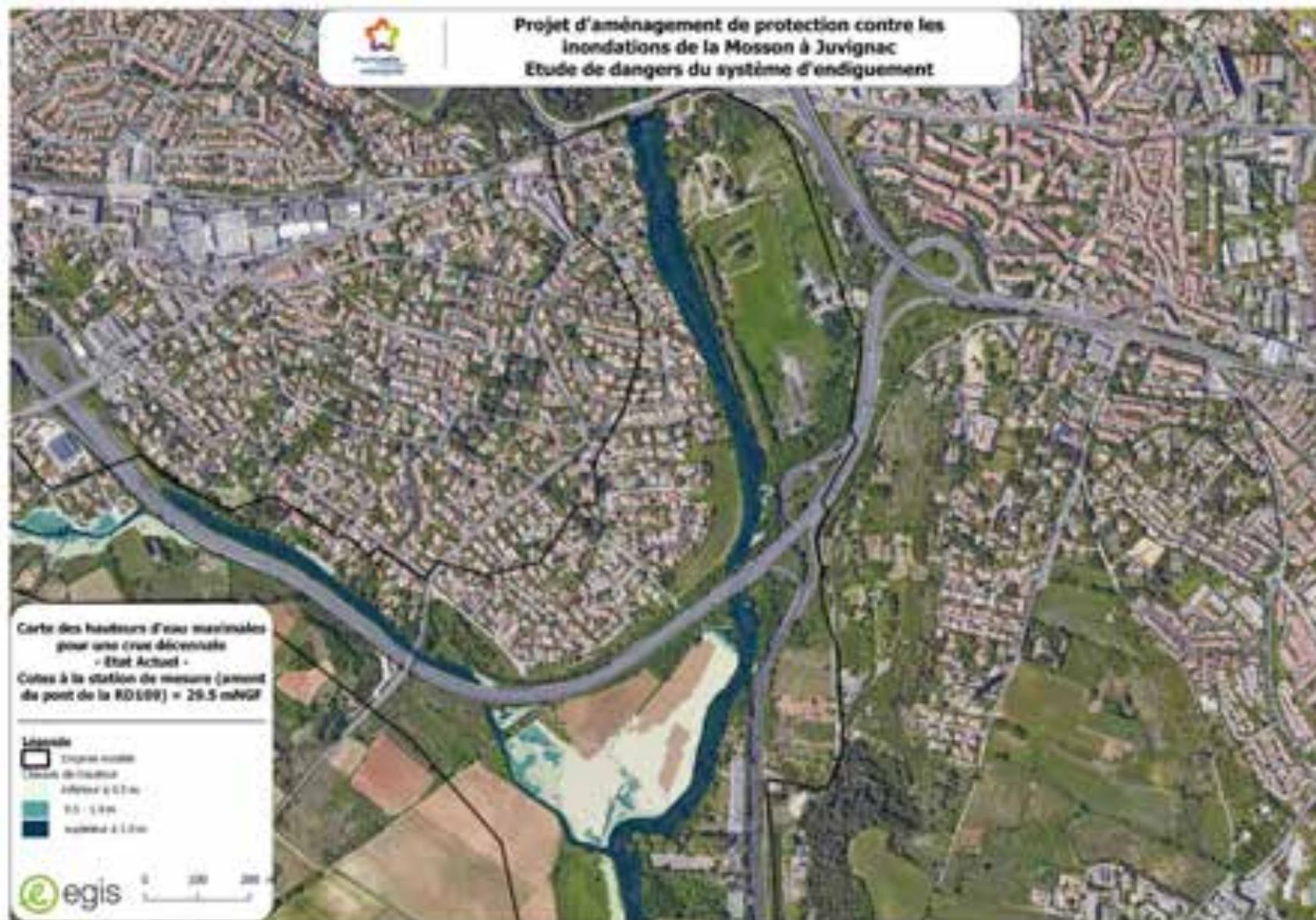
Figure 45 : Etat avant-projet – Cote à la station de mesure (amont pont RN109) : 29.5 m NGF – Carte des vitesses d'écoulement
