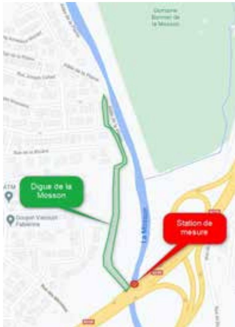
Equipée d'une sonde à ultrason, cette station permettra d'alerter le gestionnaire en temps réel sur les hauteurs de crue de la Mosson à proximité du déversoir de sécurité.
