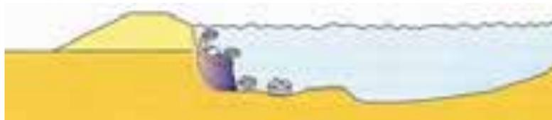
Les berges de cours d'eau peuvent être soumises au risque d'érosion par les écoulements. En effet, différents éléments peuvent conduire à l'apparition de vitesses d'écoulement localement importantes, la contrainte de cisaillement engendrée par l'écoulement sur les berges et les digues est importante. Par ailleurs, tout élément saillant se voit appliquer une force allant dans le sens de l'écoulement lié à cette vitesse.
