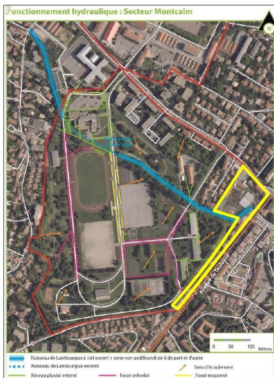
Réseau pluvial présent aux abords du projet - Extrait étude d'impact réf. E1748, EGIS juillet 2016 (gauche) Extrait du plan des réseau d'eau potable, annexes sanitaires PLU de Montpellier (droite)
